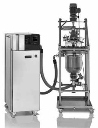
**Les systèmes de thermorégulation Unistat permettent un scale-up dans le développement du procédé, du petit réacteur de recherche à la quantité de production**
